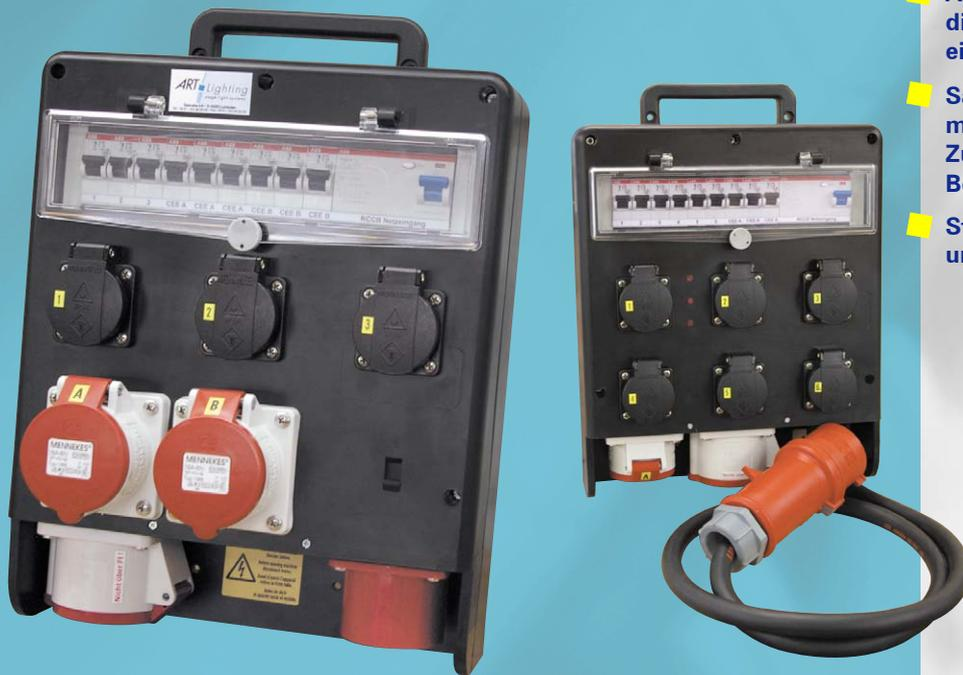
Konstruktionstechnisch bedingt kann der Netzeingang im 32A-Bereich zudem über einen Anbaustecker realisiert werden, womit man sich beim Transport das ewige Hinterherschleifen des Anschlusskabels erspart. Der verfügbare Einbauraum für Sicherungselemente macht es möglich, mehr als einen FI einzubauen, womit im Fehlerfall nicht der komplette Verteiler ausfällt.
